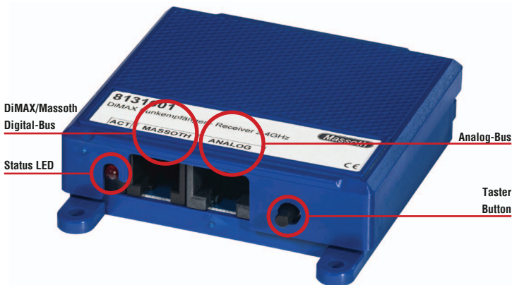
Abbildung 1: Anschluss des Funkempfängers Illustration #1: Connecting the Receiver
